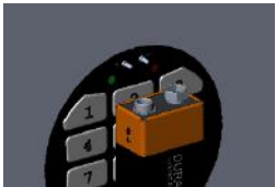
Fig. 7.1 Kontakte zur Notbestromung
